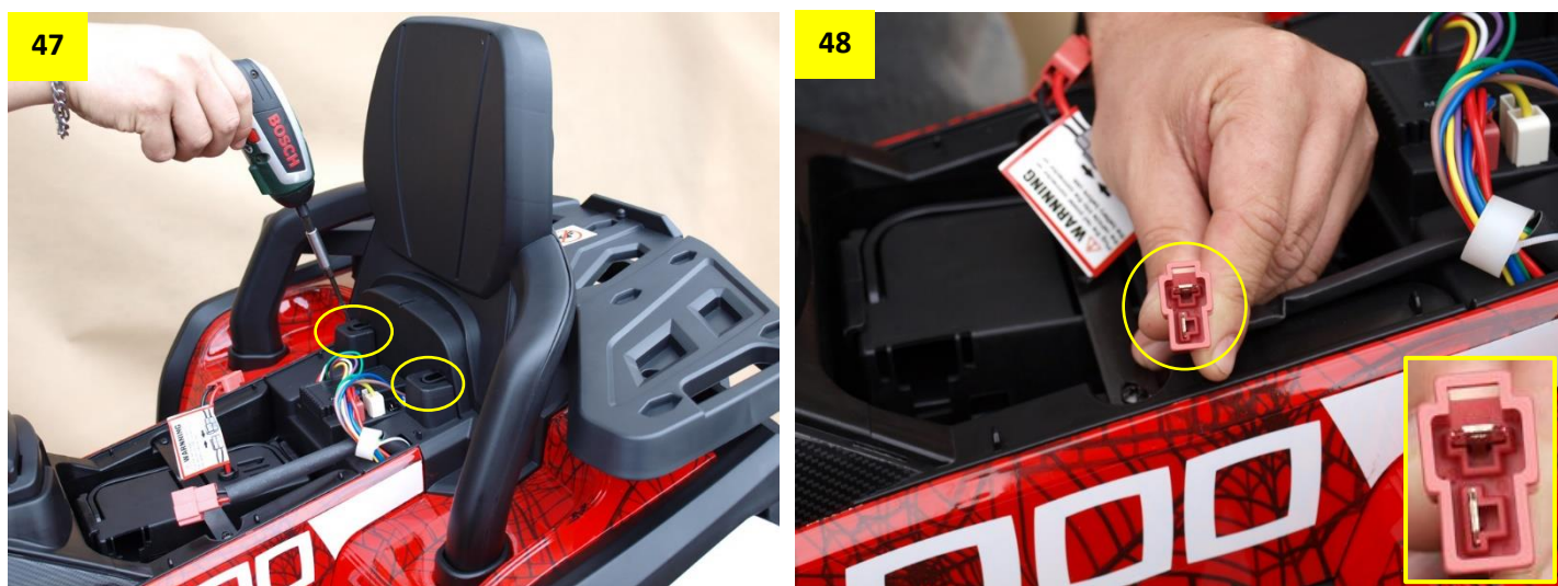
Obr. 48: Překontrolujte konektory pro zapojení baterie – mosazné packy v zástrčce musí být rovně a uprostřed. Jsou-li vychýlené ke stranám, narovnejte je prosím prstem.
