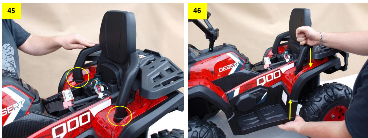
Obr. 45 a 46: Nasadte opěradlo sedačky. Opěradlo musí zapadnout nadoraz, během jeho nasazování si čtyřkolku podepřete zespod rukou jako na obrázku.
