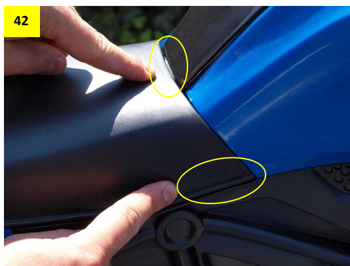
Obr. 41: Při nasazování sedačky je nutné, aby jistící kolíček zapadl do otvoru v motorce.
