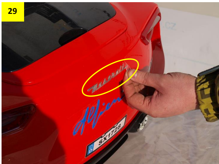
Obr. 29 a 30: Před stažením fólie logo zahradě prstem. Fólii následně opatrně stáhněte.
