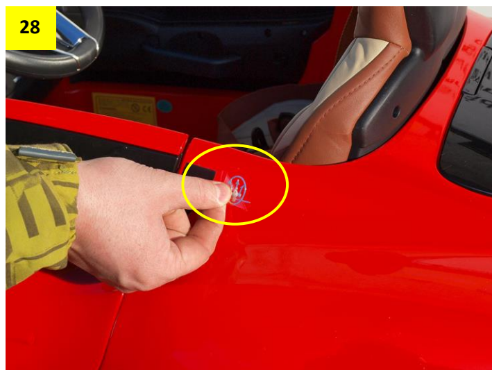
Obr. 28: Před stažením fólie logo zahradě prstem. Fólii následně opatrně stáhněte.
