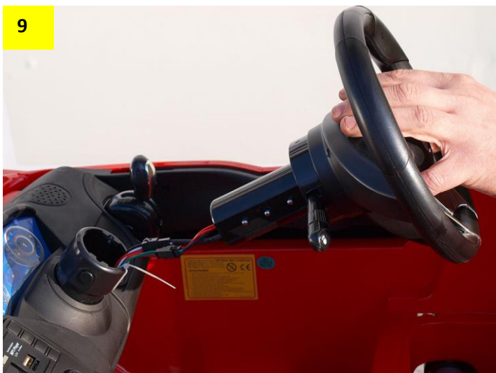
Obr. 9: Po zapojení konektorů volant stále držte, aby nedošlo k jeho pádu a následnému přetržení kabelů. Obr. 10: Odstraňte stahovací pásku. Po zapojení konektorů kabely zastrčte do otvoru a nasadte volant.
