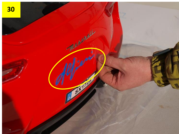
Obr. 29 a 30: Před stažením fólie logo zahradě prstem. Fólii následně opatrně stáhněte.
