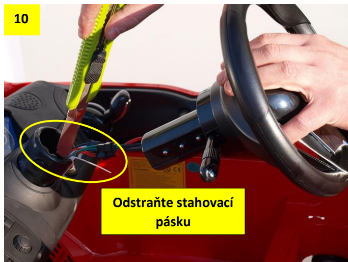
Obr. 9: Po zapojení konektorů volant stále držte, aby nedošlo k jeho pádu a následnému přetržení kabelů. Obr. 10: Odstraňte stahovací pásku. Po zapojení konektorů kabely zastrčte do otvoru a nasadte volant.
