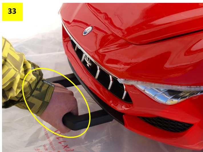
Obr. 33: Výsuvné madlo pro ruční tažení autíčka.
