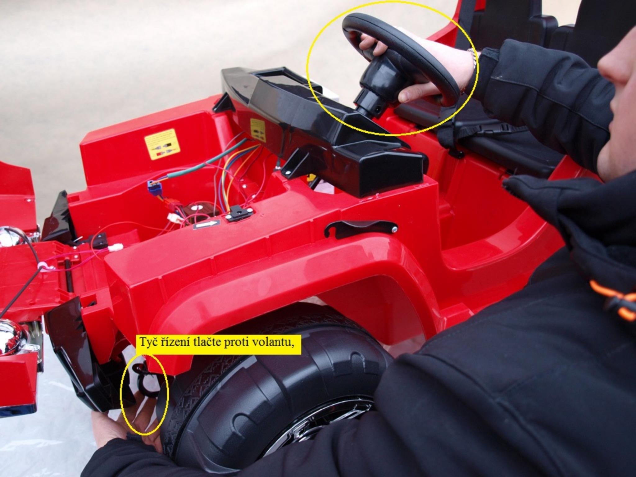
Tyč řízení tlače proti volantu,
