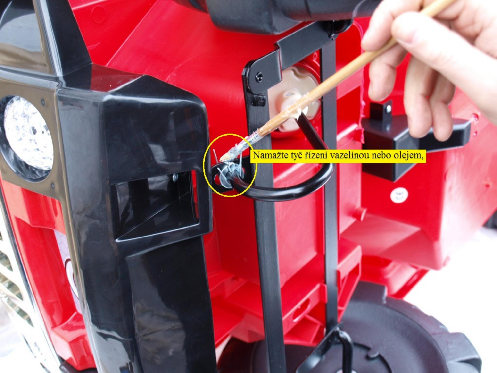
Namažte tyč řízení vazelinou nebo olejem,
