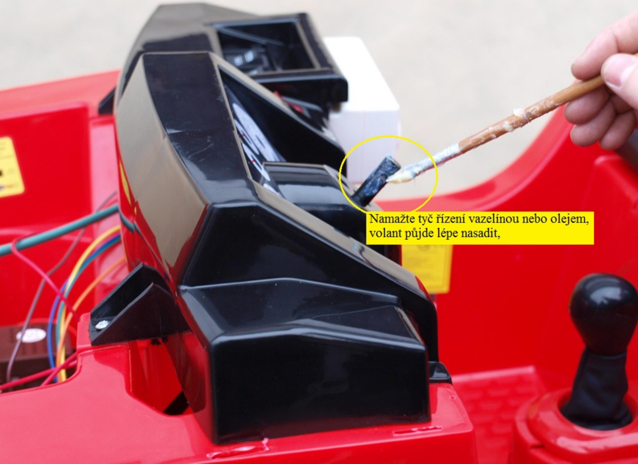
Namažte tyč řízení vazelinou nebo olejem,
