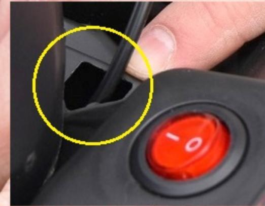
Zapojené kably a konektor srovnejte a zastrčte do otvoru pod řízením,
