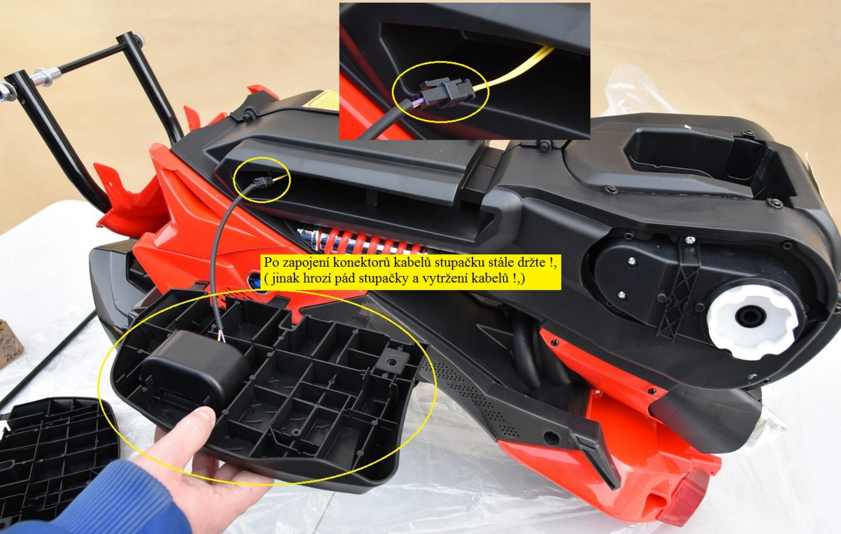
Po zapojení konektorů kabelů stupačku stále držte !,
