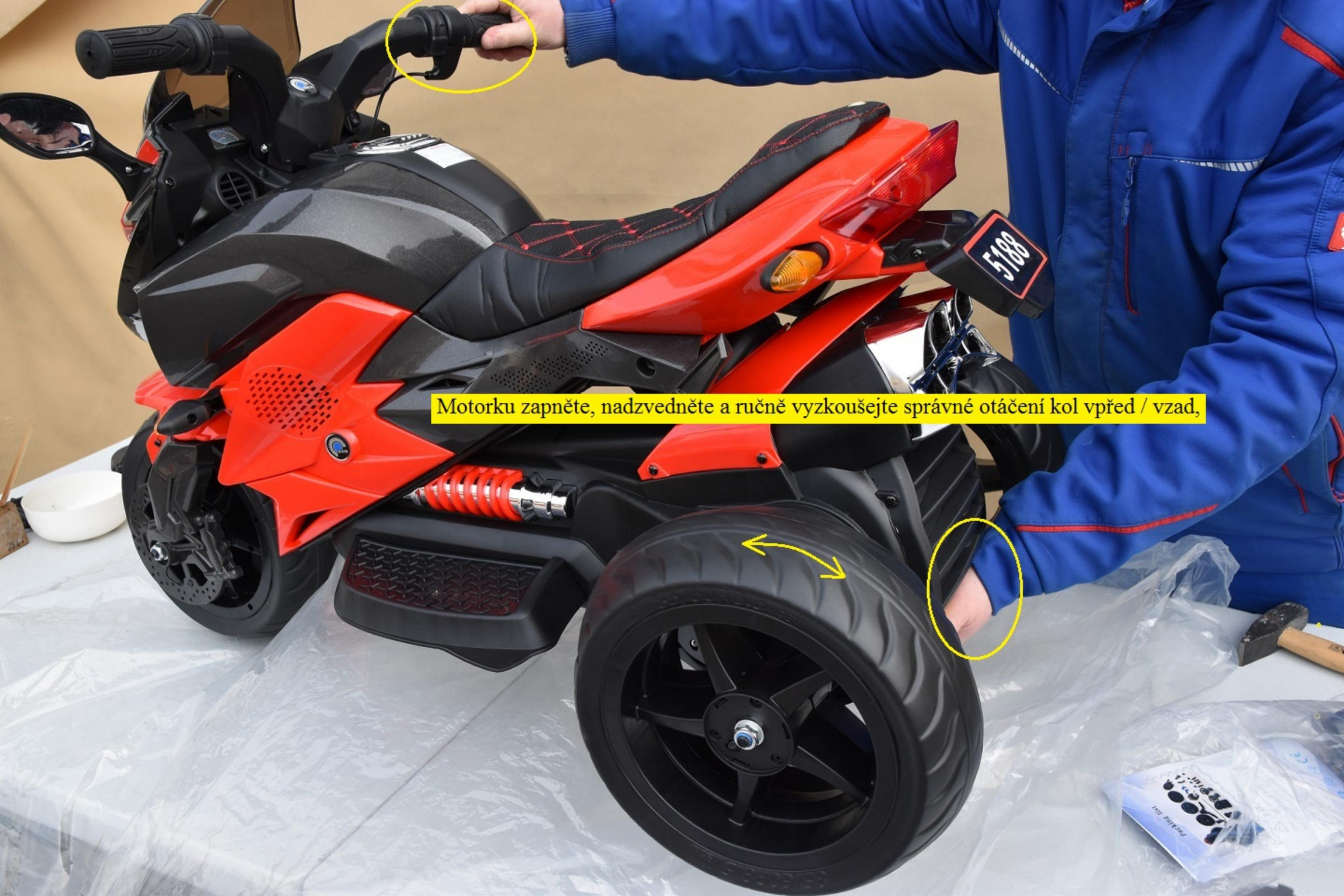
Motorku zapněte, nadzvedněte a ručně vyzkoušejte správné otáčení kol vpřed / vzad,
